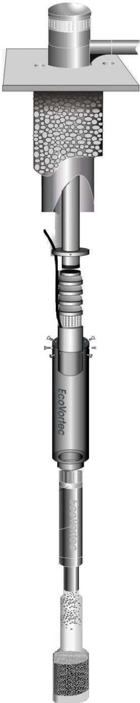
Los desarenadores sumergibles están diseñados para eliminar sólidos con peso específico de 1.8 o mayores (arena) con un rendimiento hasta de 95% y de esta forma proteger el desgaste acelerado que sufren las bombas sumergibles y turbinas verticales instaladas en pozos de agua potable y riego.
